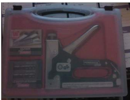
Agrafeuse pour le géotextile
